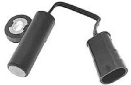
CLAVE: S35803 NUM. PARTE: SU358 SENSOR DE POSICION DEL CIGÜEÑAL CHRYSLER 94-97; DODGE 94-97; CAMIONETAS DODGE 94-97; PLYMOUTH 95-97. AUTOMOTIVE 4686236 PC73 34A004-B CSS32Z (22 148)
