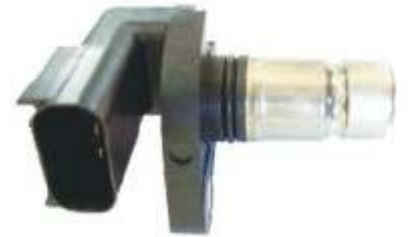
CLAVE: S30254 NUM. PARTE: SU3025 SENSOR DE POSICION DEL CIGÜEÑAL CHRYSLER 95-2002; CAMIONETAS DODGE 96-99, 01-02; MITSUBISHI 95-99; PLYMOUTH 95-00. AUTOMOTIVE 5235377 5269703 34A014-B
