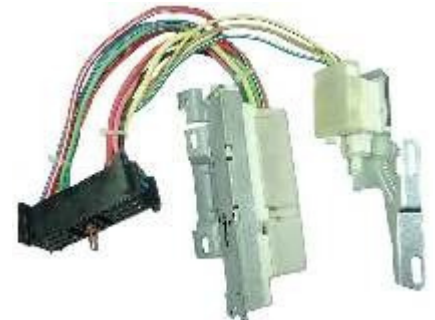
CLAVE: S32875 NUM. PARTE: KS-6434 SWITCH DE IGNICION COLUMNA C/CAMBIO DE LUZ A LA FUNDA AUTOMOTIVE GM 88-94 LS-544
