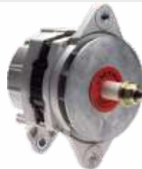
CLAVE: A27407 NO. PARTE: 42740 ALTERNADOR RCP DELCO 21SI 24V 70A
